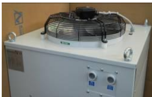
Figura 23 – Posizione del ventilatore
