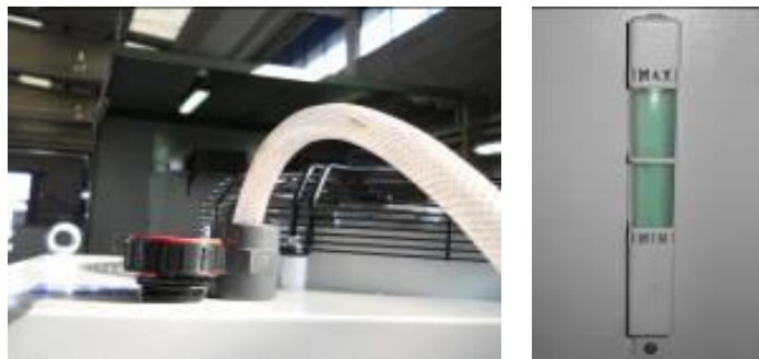
Abbildung 11 / 12 – Befüllverfahren und Höchststand
