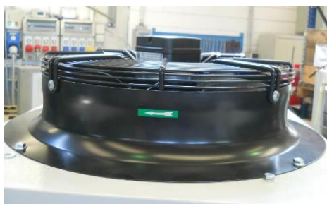
Figura 20 – Esempio di direzione di rotazione del ventilatore
