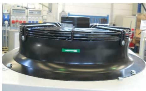
Figure 20 – Exemple de sens de rotation du ventilateur
