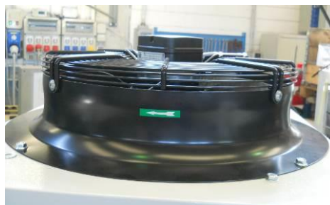
Рис 20 – Пример направления вращения вентилятора
