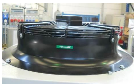
Figura 20 – Ejemplo de dirección de rotación del ventilador
