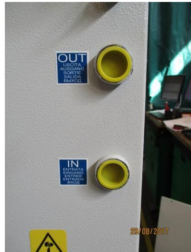
Abbildung 4 – Platte für Hydraulikanschlüsse
