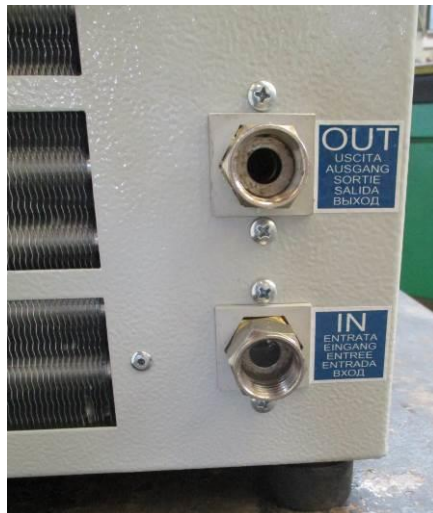
Figura 3 – Piastra connessioni idrauliche
