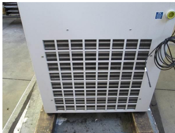
Picture 21 – Surface extérieure du condenseur pour CCE 6401 – 6501 - 6601
