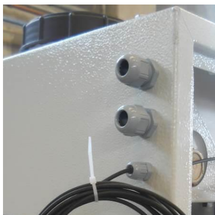
Figura 5 – Placa para conexiones eléctricas
