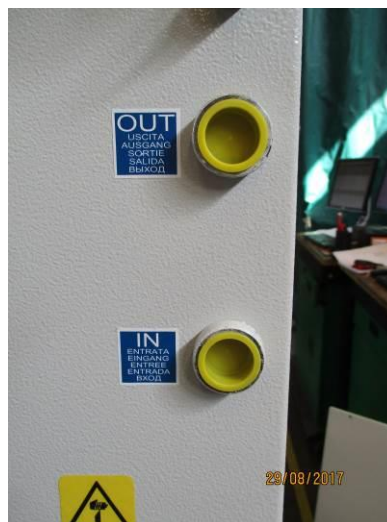
Figura 4 – Placa para las conexiones hidráulicas
