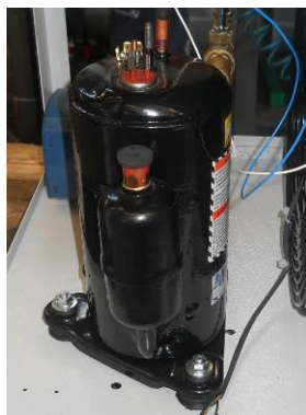
Abbildung 17– Kompressor Platzierung für CCE 6101 – 6201 – 6301
