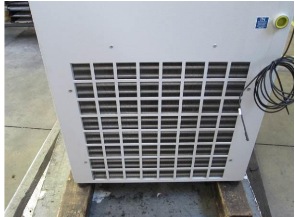
Picture 21 –Verflüssige Außenfläche für CCE 6401 – 6501 - 6601
