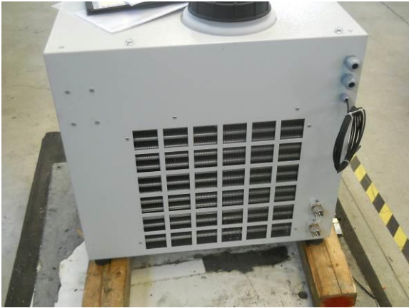
Figura 20 – Superficie esterna condensatrice per CCE 6101 – 6201 – 6301
