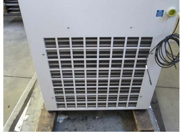
Figura 21 – Superficie esterna condensatrice per CCE 6401 – 6501 - 6601
