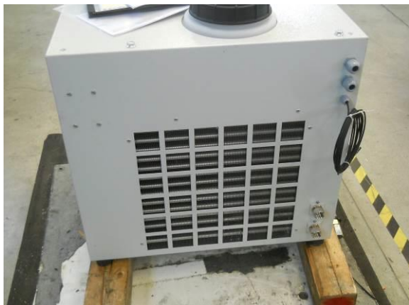
Рис. 20 – Внешняя поверхность конденсатора для CCE 6101 – 6201 – 6301
