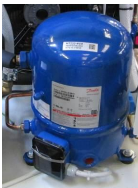
Figura 17 – Colocación del compresor para CCE 6101 – 6201 – 6301
