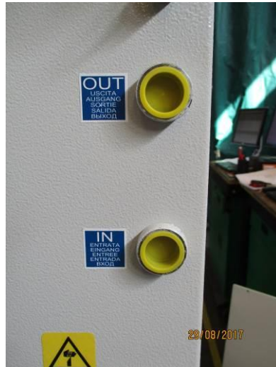
Figura 4 – Piastra connessioni idrauliche
