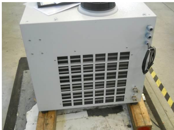
Picture 20 – Surface extérieure du condenseur pour CCE 6101 – 6201 – 6301
