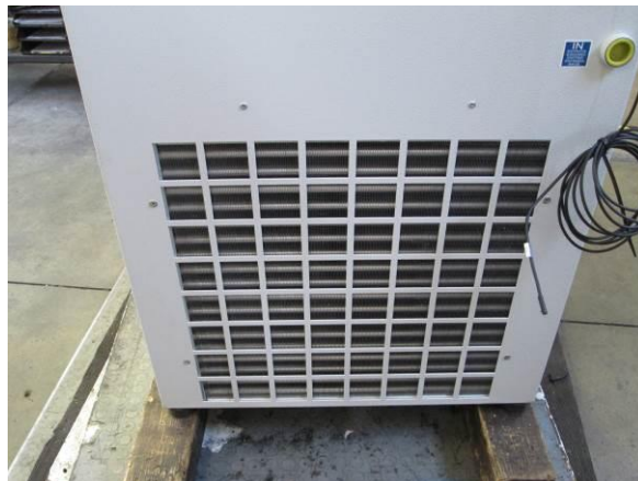
Рис. 20 – Внешняя поверхность конденсатора для CCE 6101 – 6201 – 6301
