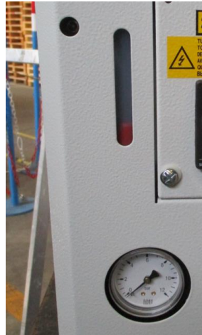
Abbildung 10 – Befüllverfahren und Höchststand
