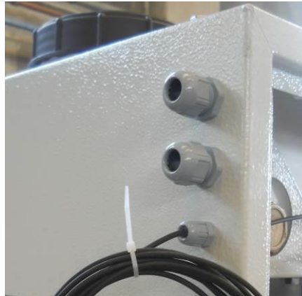
Abbildung 5 – Platte für Stromanschlüsse
