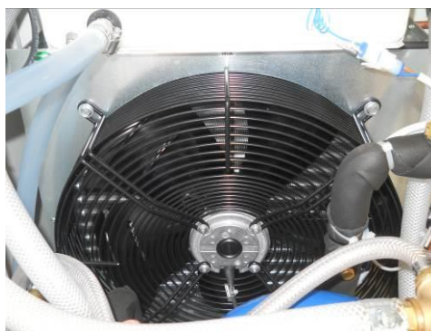
Picture 19 – Fan placement
