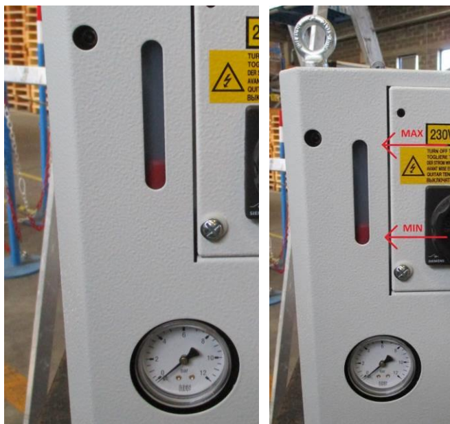
Figure 14 / 15 – Recharge du réservoir
