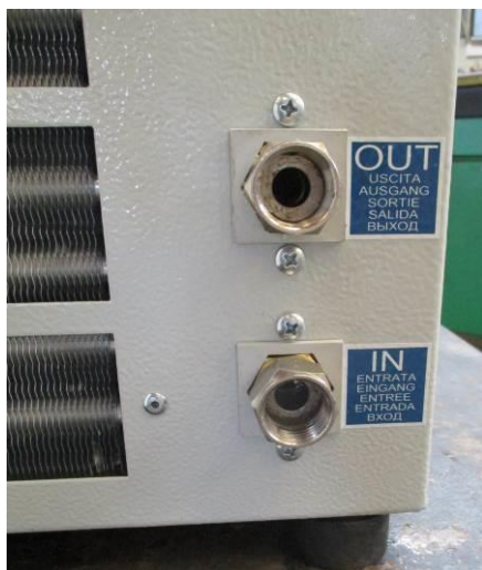
Figura 3 – Placa para las conexiones hidráulicas
