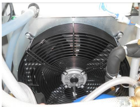
Figure 19 – Position du ventilateur
