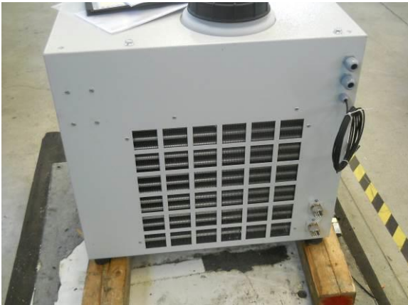
Picture 20 – Verflüssige Außenfläche für CCE 6101 – 6201 – 6301
