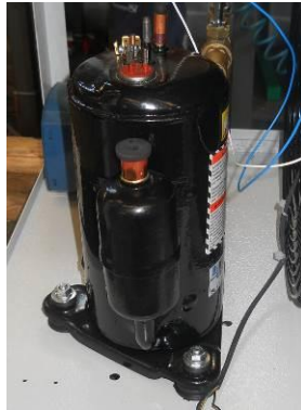
Рис. 17 – Размещение компрессора для CSE 6101 – 6201 – 6301
