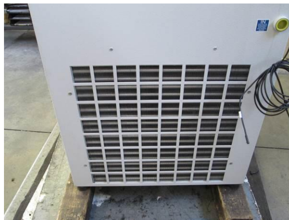
Picture 21 – Superficie externa del condensador para CCE 6401 – 6501 - 6601
