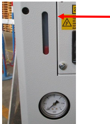
Figure 10 – Procédure de remplissage et niveau maximum
