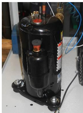
Figura 17 – Colocación del compresor para CCE 6101 – 6201 – 6301
