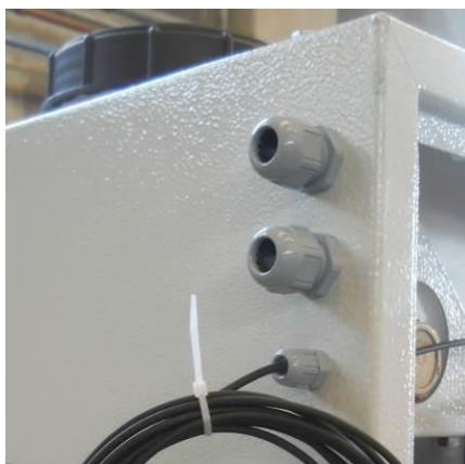
Рис. 5 – Планка для электрических подключений
