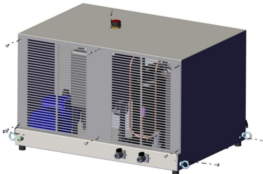
Figure 14 – Viti da rimuovere per accedere all'interno del refrigeratore
