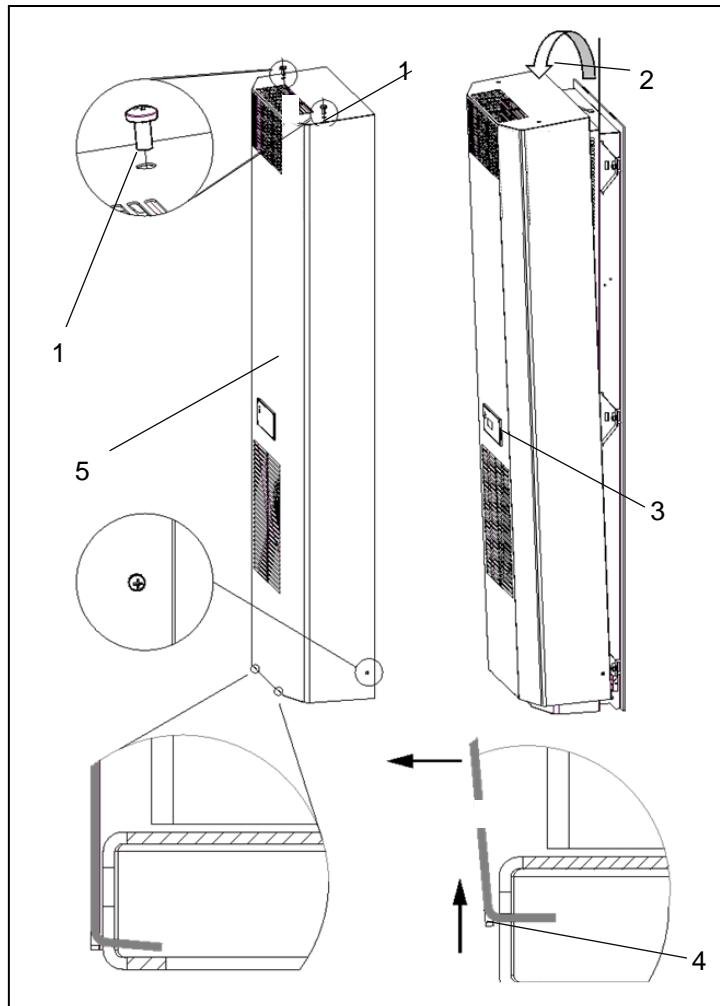
Рис. 19 – Демонтаж кожуха устройства
