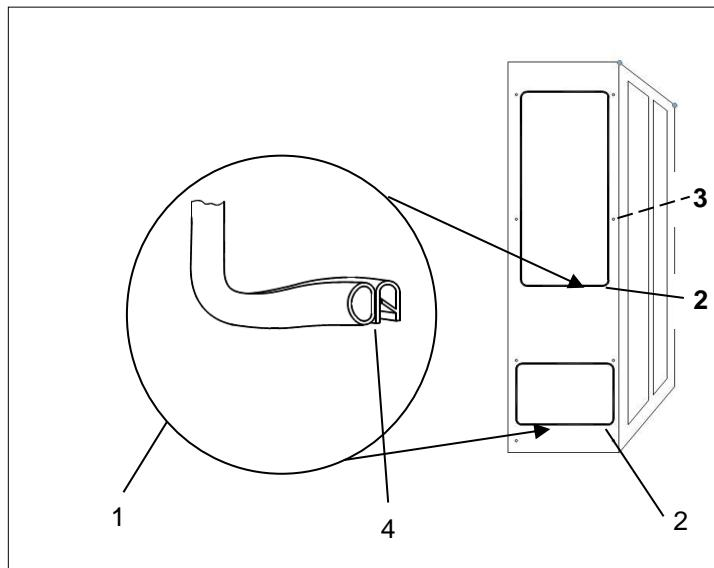
Figura 10: Colocación del sellado del perfil
