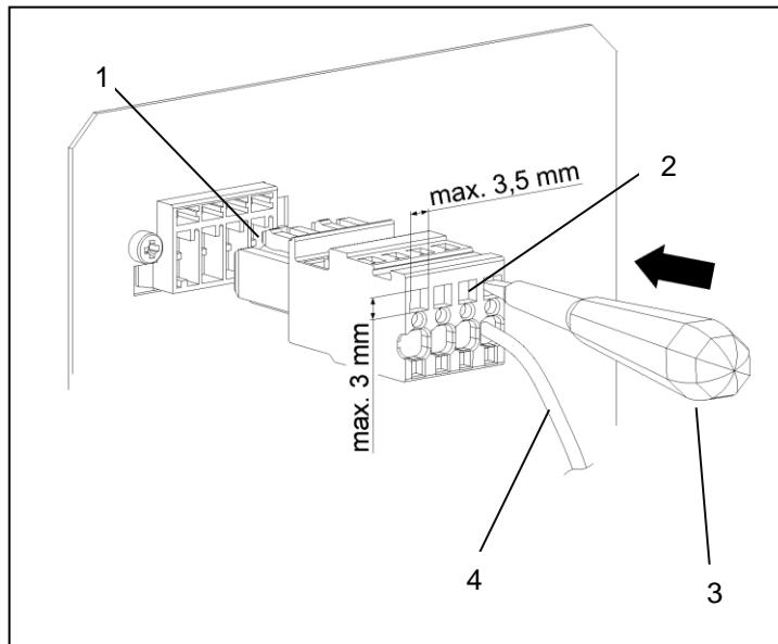
Figura 13: Conexión del enchufe del climatizador
