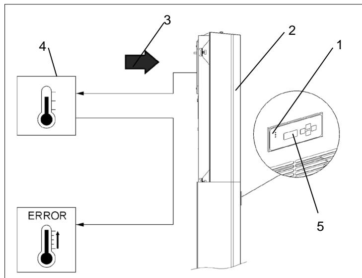
Рис. 15 - Работа электронного управления
