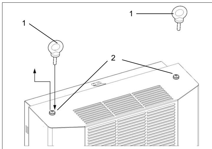
Figure 6 - Oreilles de levage M8 sur climatiseurs DTI/DTS
