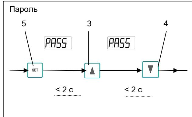
Рис. 17 - Комбинация клавиш пароля (MC)
