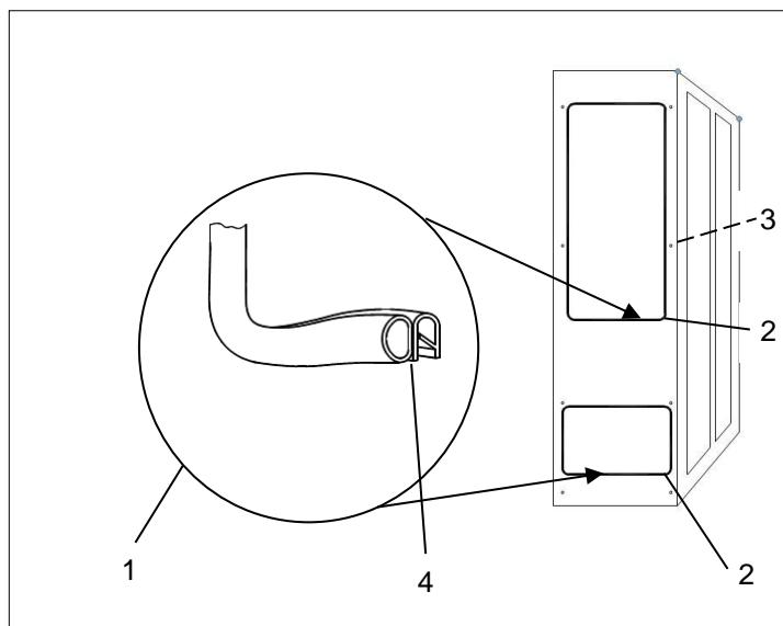
Figure 9 - Poser les joints de profilé
