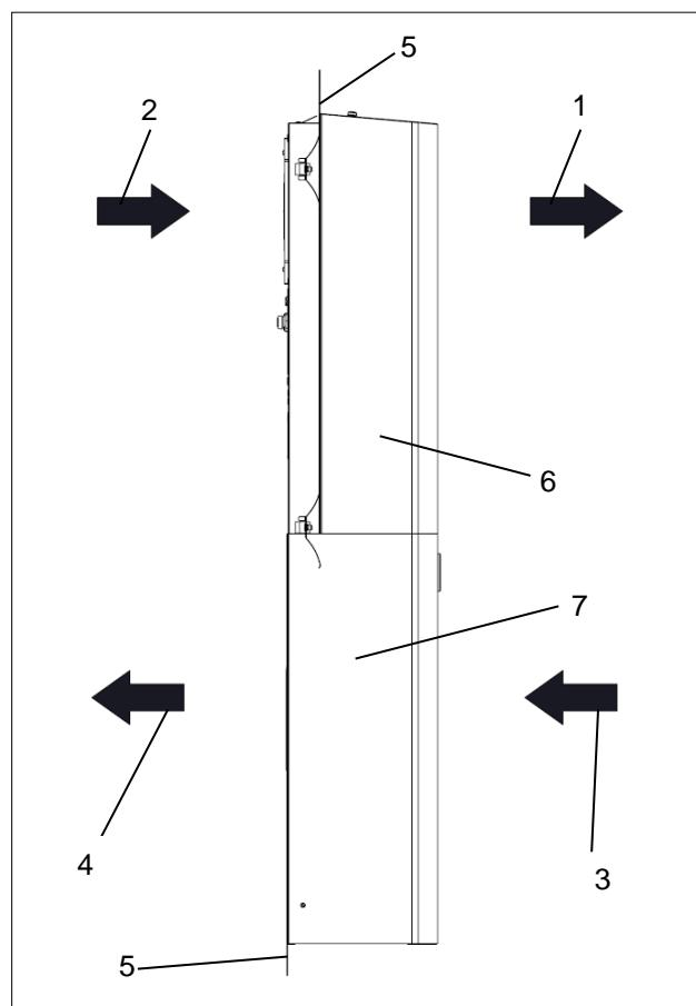
**Рис. 2 - Вид сбоку, принцип воздушного потока-распределительный шкаф DTS/DTI**
