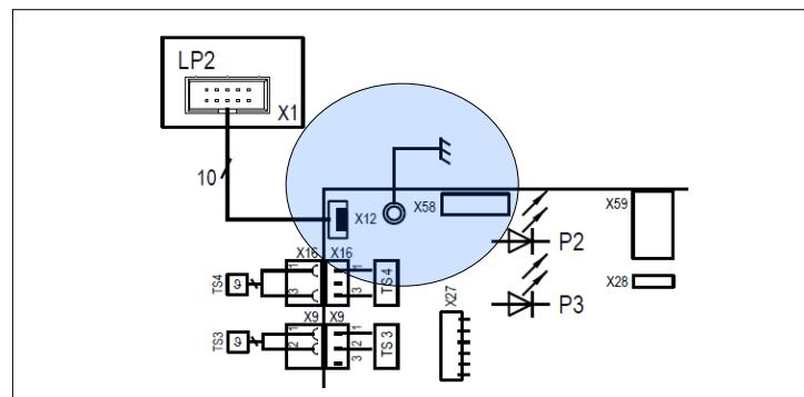
Abbildung 13 – Modbus-RTU-Schnittstelle (X58)
