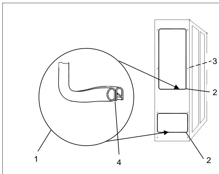
**Рис. 9 - Установка профильного уплотнения
