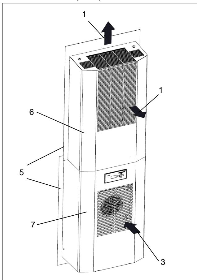
Abbildung 1 - Frontansicht Luftstrom-Prinzip
